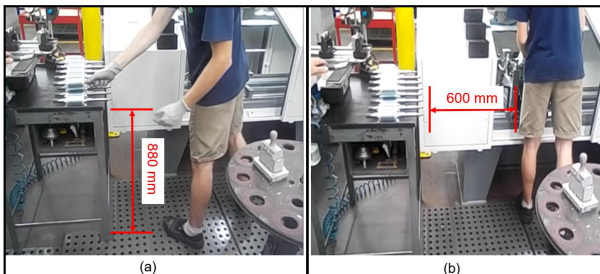
Figura 12 - Operação de balancear: (a) Selecionando o rotor; (b) Posicionando o rotor no balanceador
