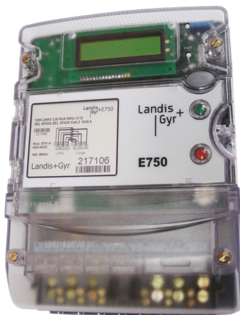
Figura 8 – Medidor eletrônico modelo E750 da empresa Landys+Gyr
