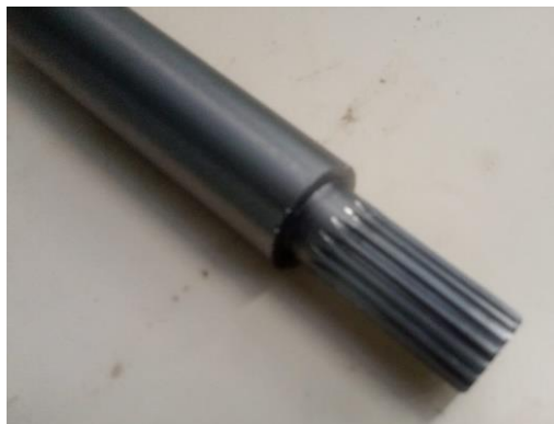
Figura 15 – Peça acabada do acoplamento mecânico do motor elétrico ao câmbio original do veículo
