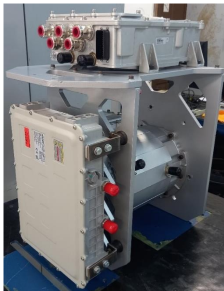
Figura 19 – Versão final testada e validada do berço/cofre do motor em aço carbono
