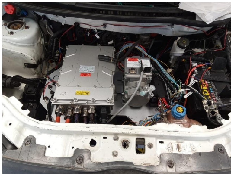
Figura 25 – Montagem final do berço/cofre no veículo convertido
