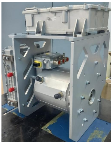
Figura 18 – Versão final testada e validada do berço/cofre do motor em aço carbono
