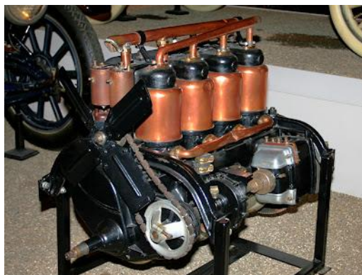
Figura 5 – Motor de arranque com sistema de ignição elétrica por Kettering
