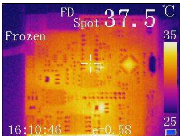
Fig. 15. Visão térmica da PCI de interface após uma hora de operação
