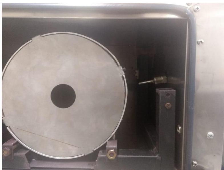
Figura 13 - Posição do sensor PT-100 no forno.
