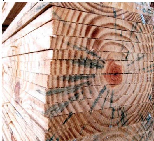
Figura 3 - Ataque de fungos manchadores em madeira de Pinus taeda
