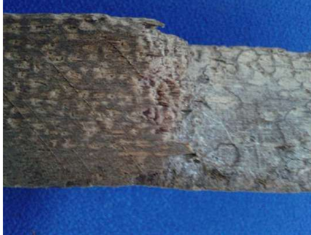
Figura 4 - Madeira infectada com fungos de podridão branca
