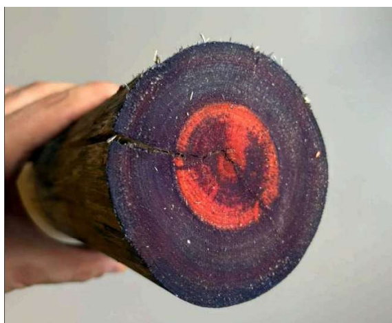
Figura 27 - Ensaio realizado em peça de eucalipto com o reagente Cromo Azurol.
