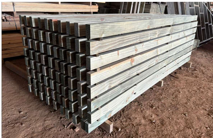
Figura 25 - Elementos estruturais em estoque da Empresa A.
