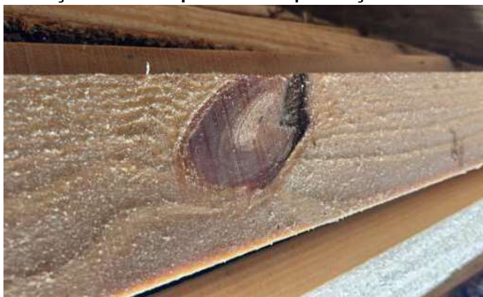
Figura 15 - Peça serrada de pinus com a presença de nó não conforme
