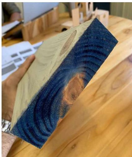
Figura 41 - Peça de pinus testada com reagente Cromo Azurol.
