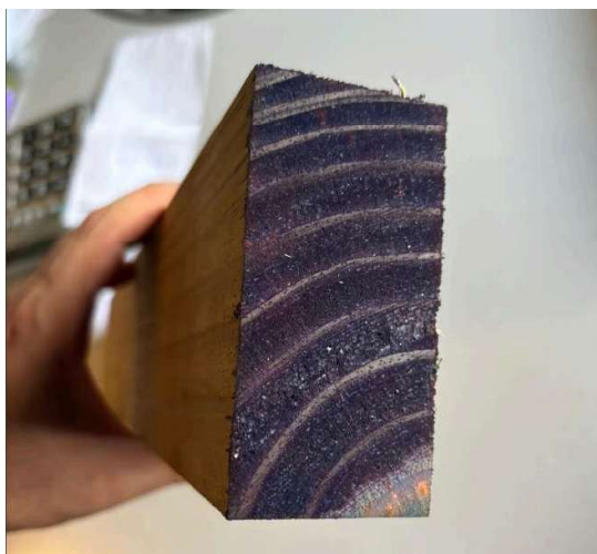
Figura 26 - Ensaio realizado em peça de pinus com o reagente Cromo Azurol.
