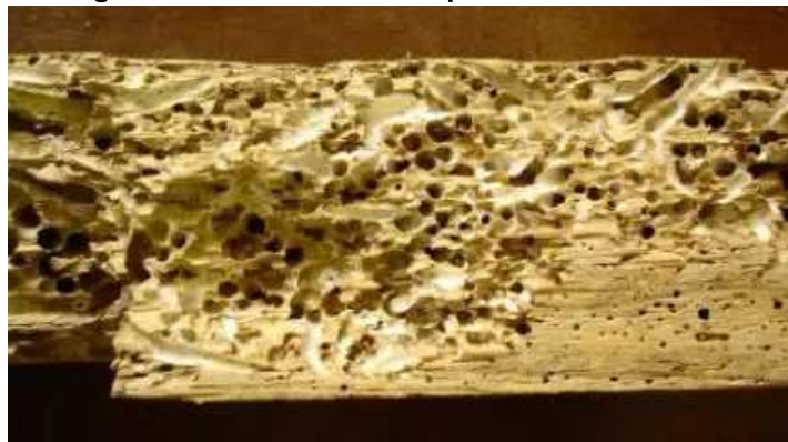
Figura 6 - Madeira atacada por brocas marinhas
