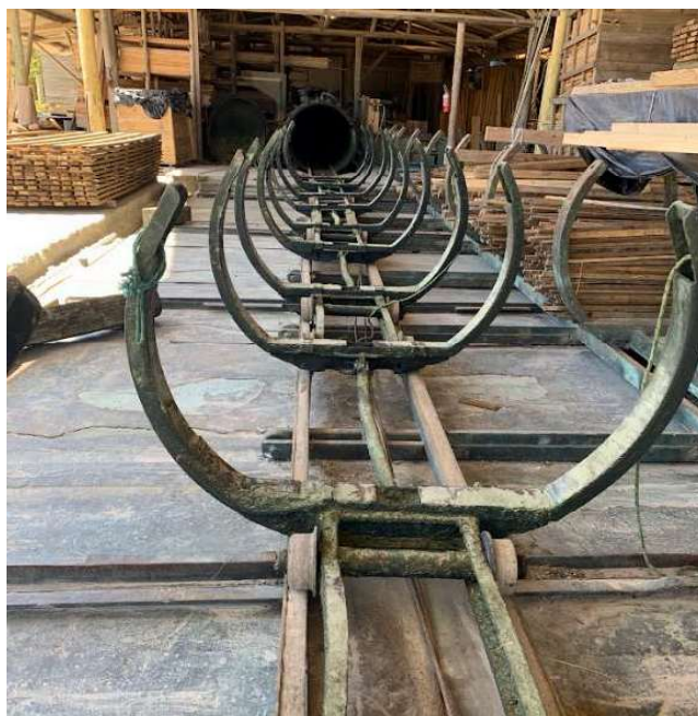
Figura 40 - Zona de gotejamento pós tratamento.
