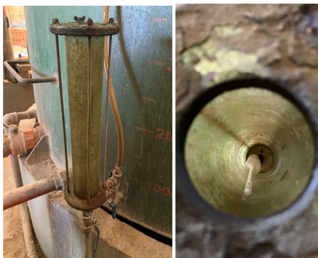
Figura 37 - Densímetro utilizado para controlar a concentração.
