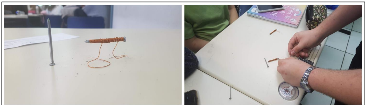
Figura 9 – Eletroímã construído e teste de um eletroímã
