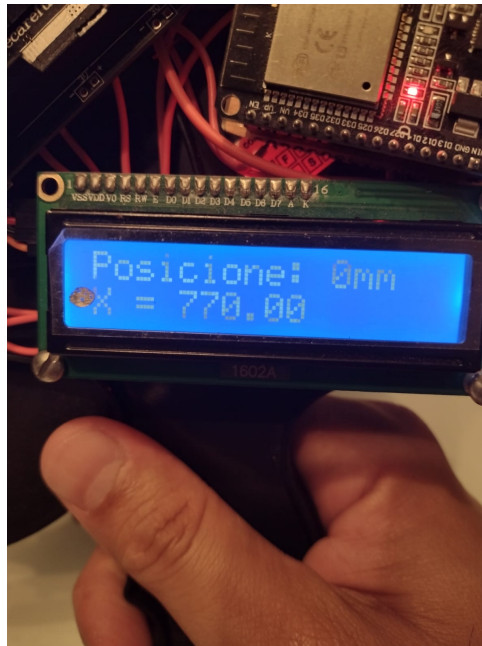
Figura 35: Protótipo lendo um valor mapeado de 770 a partir da leitura do nível de tensão equivalente ao zero do adipômetro.
