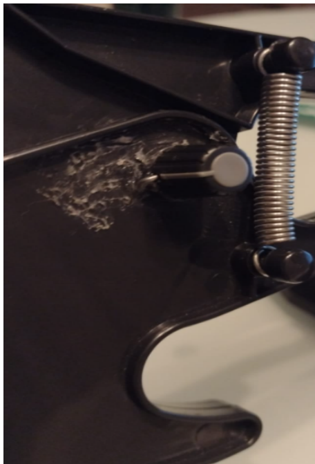
Figura 12: Knob fixado à haste metálica e ambos fixados no eixo de rotação do adipômetro.
