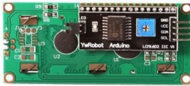
Figura 21: Display LCD 16x2 com módulo I2C acoplado, visão inferior.
