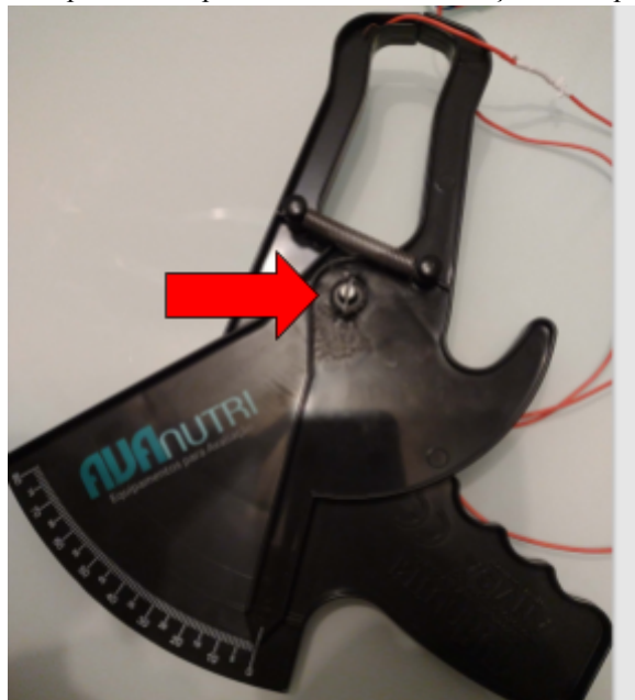
Figura 10: Substituição do pino de acoplamento do eixo de rotação do adipômetro, visão posterior.
