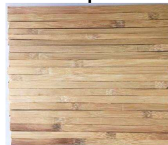
Figura 9 – Taliscas aplainadas e usinadas
