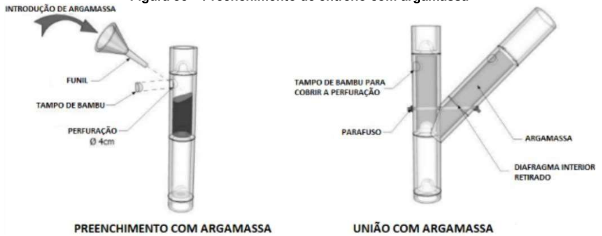
Figura 85 – Preenchimento de entrenó com argamassa
