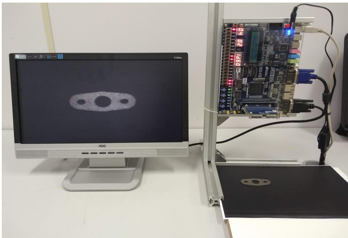
Figura 42 - Junta posicionada no sistema de inspeção
