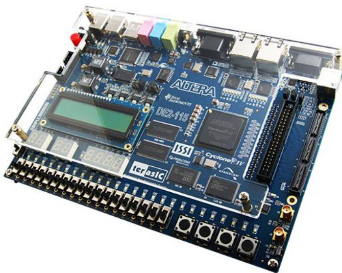
Figura 19 - Placa de desenvolvimento DE2-115
