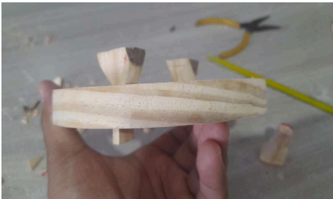
Figura 47 - Base de madeira com suporte para prender ao gesso preso por cunhas
