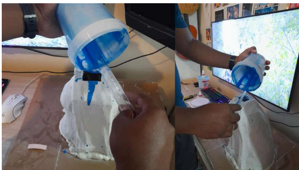
Figura 42 - Preenchimento do espaço entre produto e silicone
