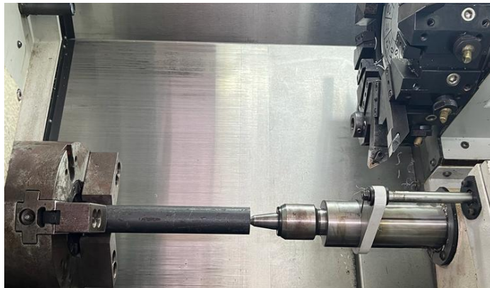
Figura 38: Material bruto posicionado e pronto para usinagem
