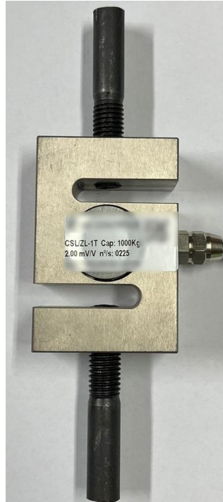
Figura 45: Conjunto da célula de carga comercial
