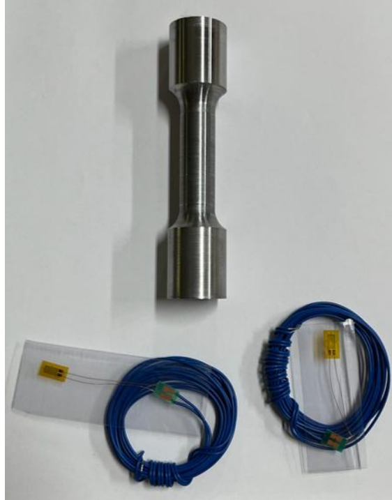
Figura 42: Corpo da célula e dois os extensômetros antes da colagem
