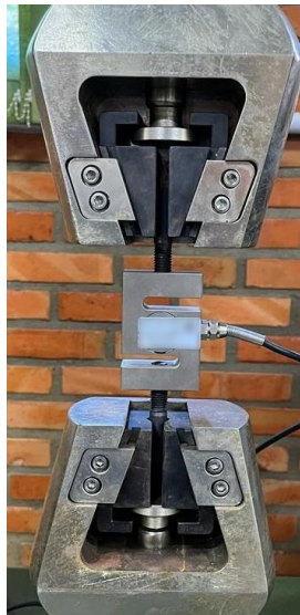
Figura 57: Posicionamento do conjunto da célula de carga adquirida
