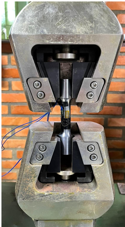
Figura 55: Posicionamento na máquina universal de ensaios
