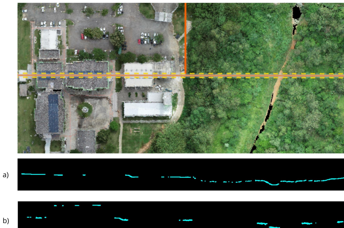
Figura 16: Seção Transversal dos pontos de solo da área 1 obtido com o Matrice (a) e com o Ebee (b)
