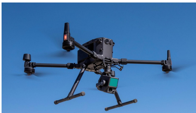
Figura 7: Drone DJI Matrice 300 com sensor Zenmuse L1.
