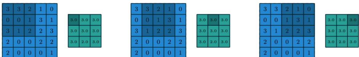
Figura 20: Operação de Max Pooling . Fonte: (SANTOS, 2021).
