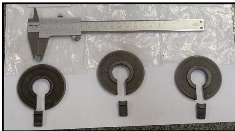
Figura 5. Corte de amostras para teste de dureza.
