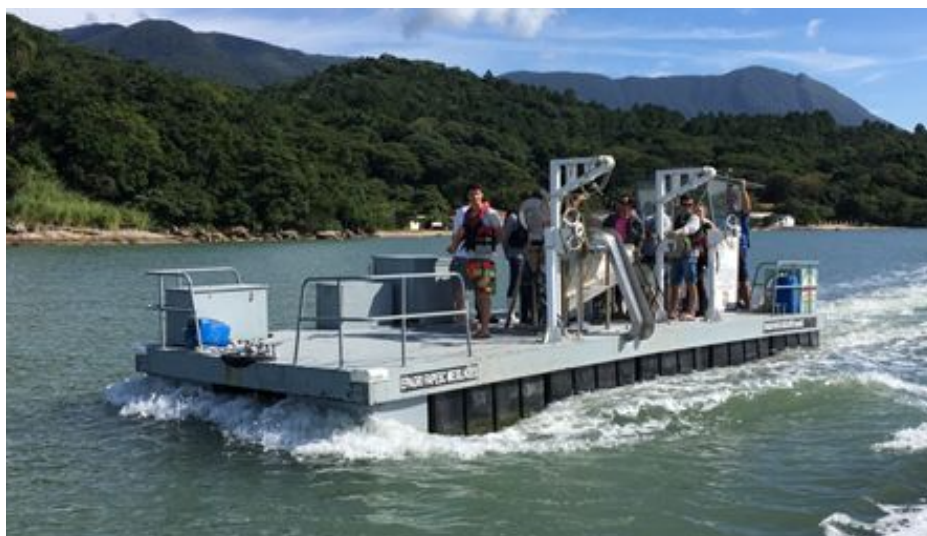
Figura 8 - Plataforma mecanizada para a colheita de mexilhões
