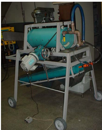
Figura 7 - Sistema mecânico de limpeza e classificação de ostras
