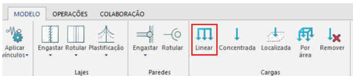
Figura 19 – Lançamento de cargas de parede sobre laje
