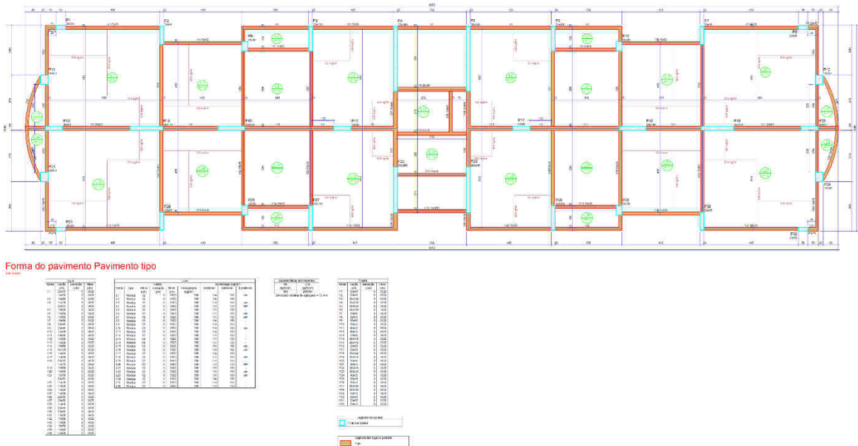
Figura 2 – Planta de formas do pavimento tipo
