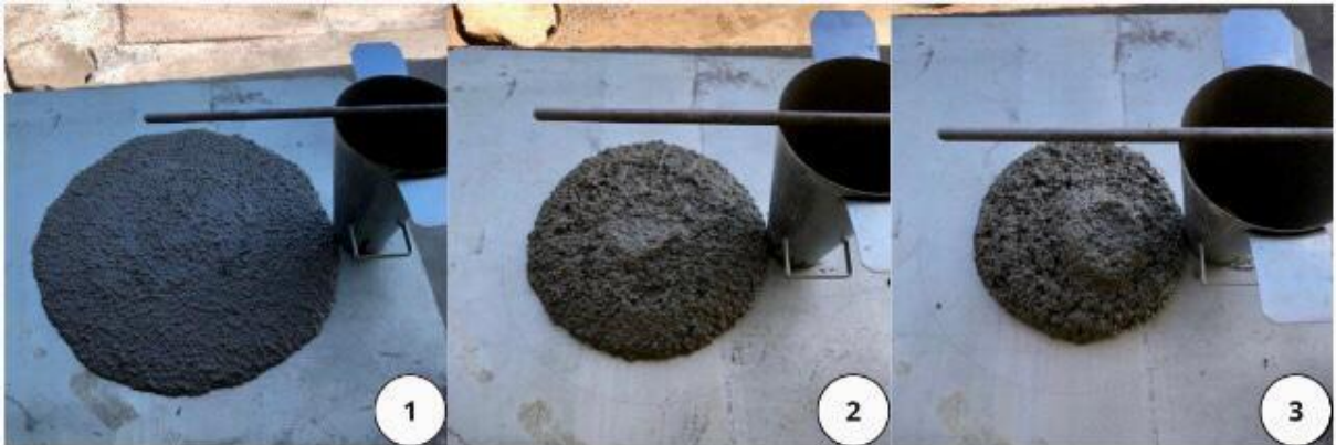
Figura 21 - Diferentes abatimentos no concreto: (1) Elevado teor de aditivo - ensaio com 30%; (2) Teor ideal de brita - ensaio com 35%; (3) Elevado teor de brita - ensaio com 37,5%.
