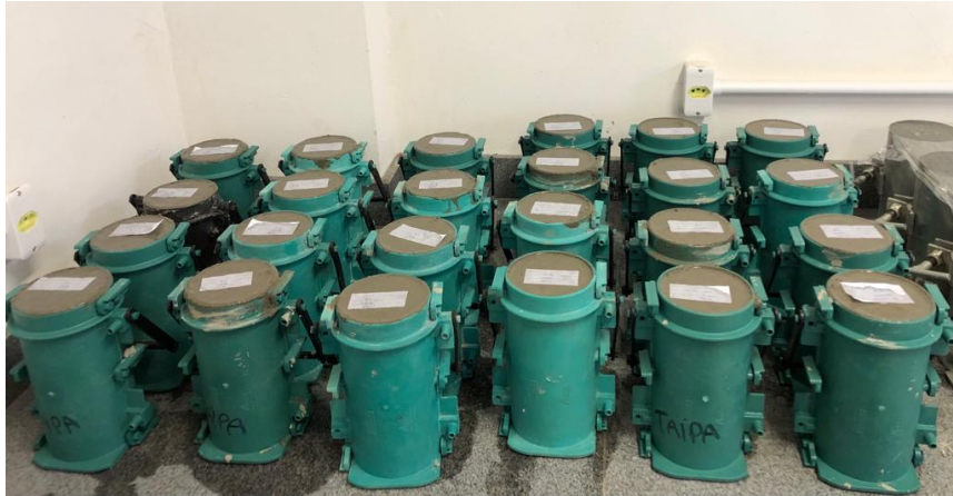
Figura 14 - Moldes dos CPs de concreto com 5% e 10% de substituição
