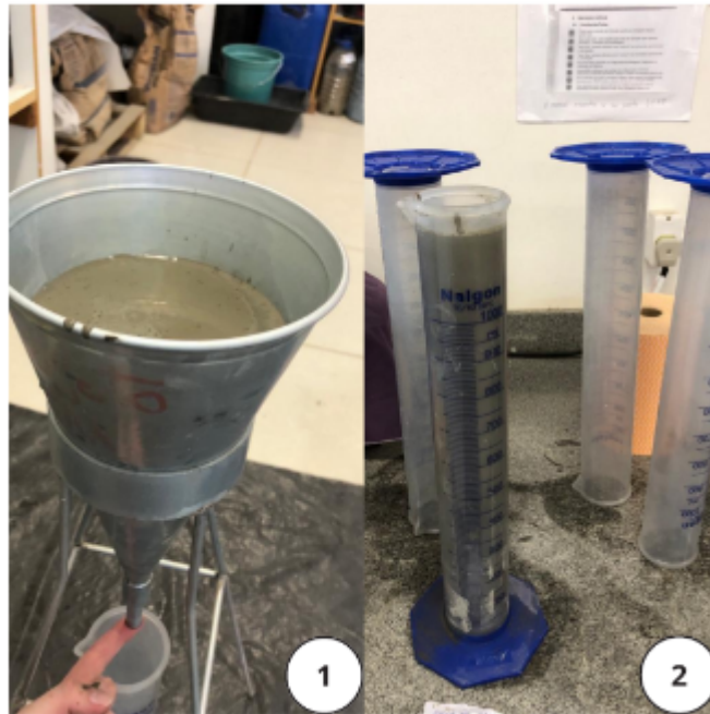
Figura 10 - Ensaio pelo Cone de Marsh: (1) Início do ensaio; (2) Pipeta após o escoamento da pasta.
