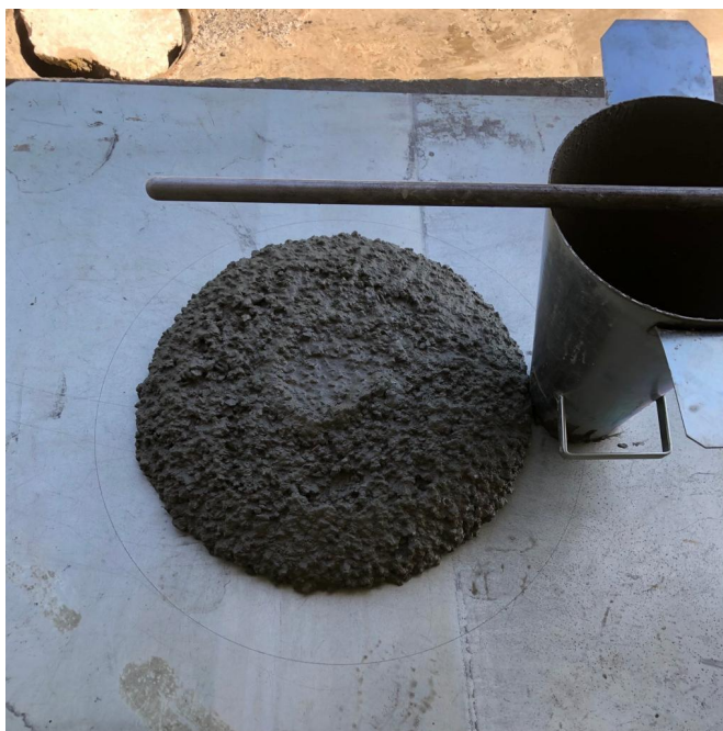
Figura 13 - Slump Test para determinação do teor de agregado graúdo
