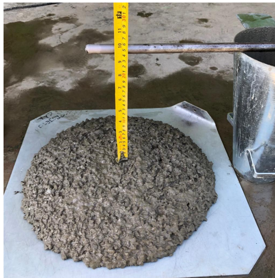
Figura 15 - Ensaio de abatimento (Slump Test)
