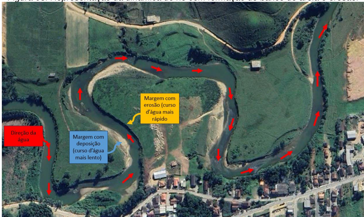
Figura 05. Representação da dinâmica do rio com formação de banco de areia e erosão.
