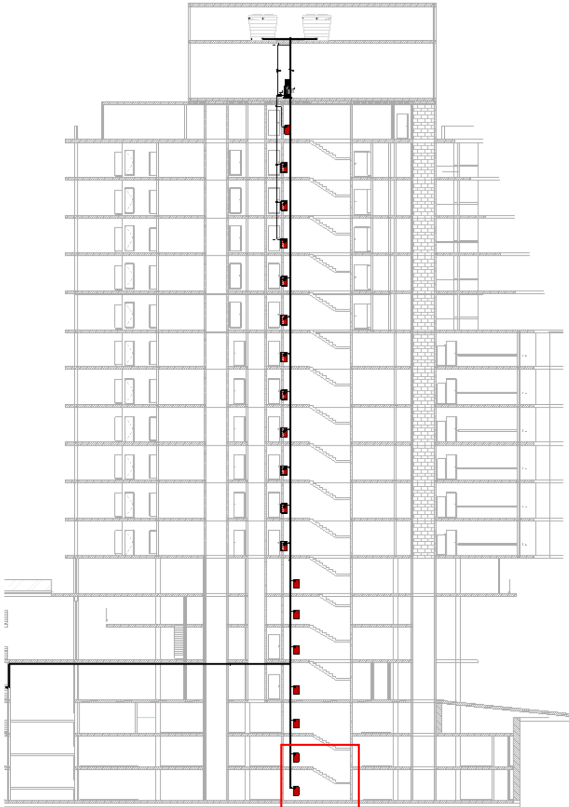
Figura 17 - Esquema Vertical Hidrantes mais Favoráveis (Torre A)
