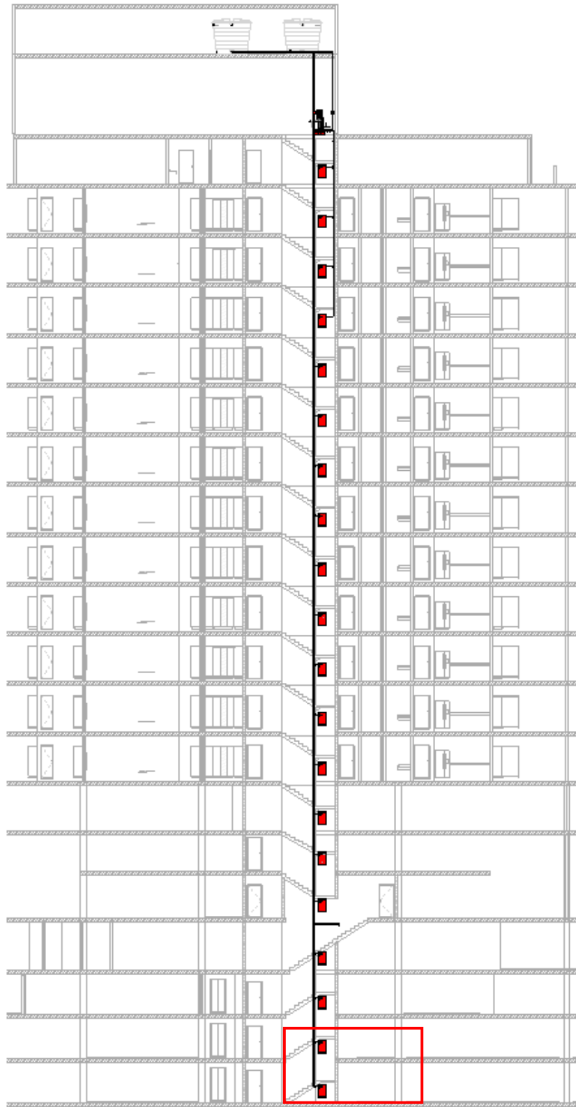
Figura 23 - Esquema Vertical Hidrantes mais Favoráveis (Torre B)
