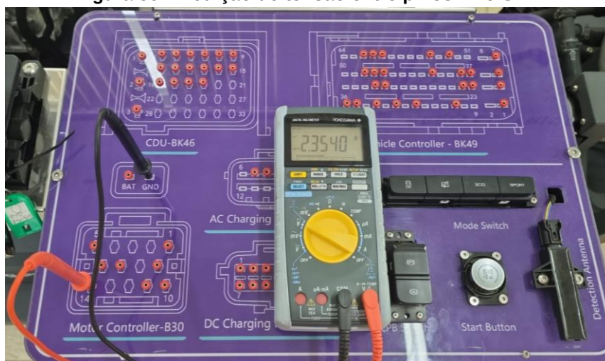
Figura 59 - Medição de tensão entre pinos 14 e GND
