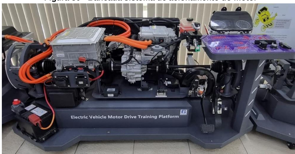
Figura 30 - Bancada sistema de acionamento do motor
