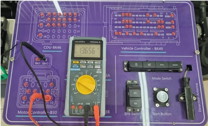
Figura 61 - Medição de tensão entre pinos 10 e GND
