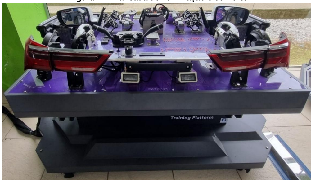
Figura 27 - Bancada de iluminação e conforto
