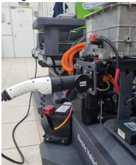
Figura 49 - Carregador conectado à bancada do Powertrain
