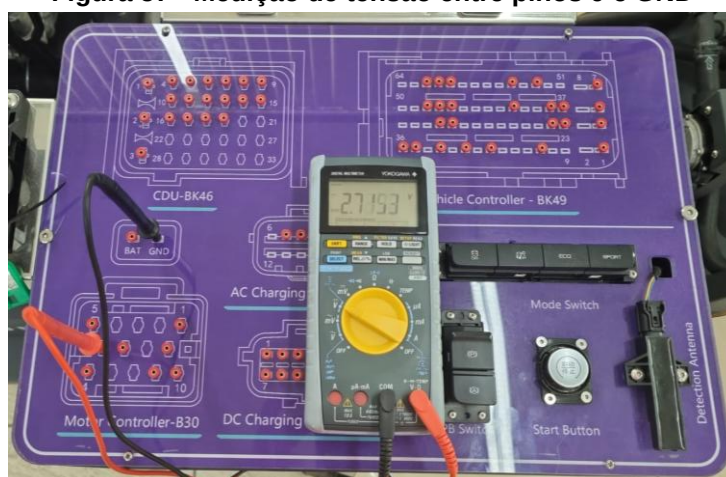
Figura 57 - Medição de tensão entre pinos 9 e GND
