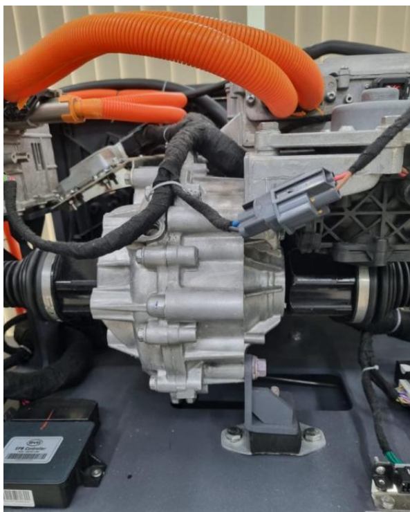
Figura 25 - Caixa de redução do BYD Qin EV
