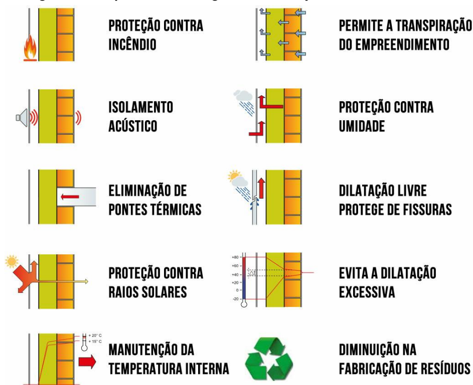
Figura 4 – Esquema de vantagens na utilização da fachada ventilada
