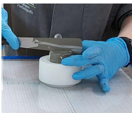
Figura 8 - Ensaio do cone de Kantro
