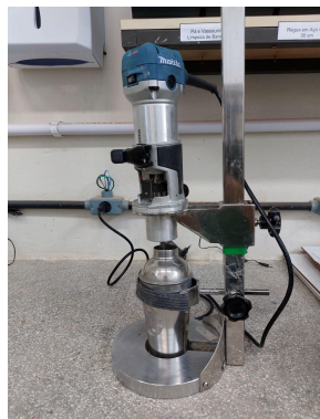
Figura 6 - Misturador de alta eficiência
