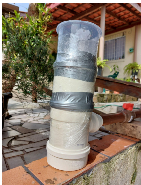
Figura 12 - Ensaio de permeabilidade
