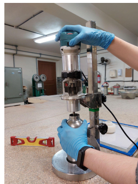
Figura 7 - Misturador de alta eficiência
