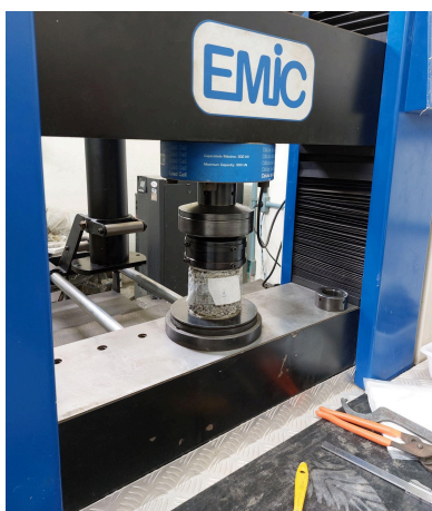
Figura 16 - Ensaio de resistência à compressão na prensa universal
