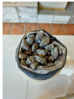
Figura 13 - Ensaio de permeabilidade
