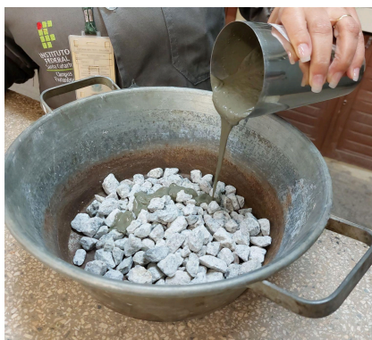
Figura 10 - Mistura da pasta com os agregados selecionados
