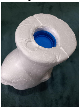
Figura 10 . Verificação da ampliação do orifício para a fixação da garrafa,
