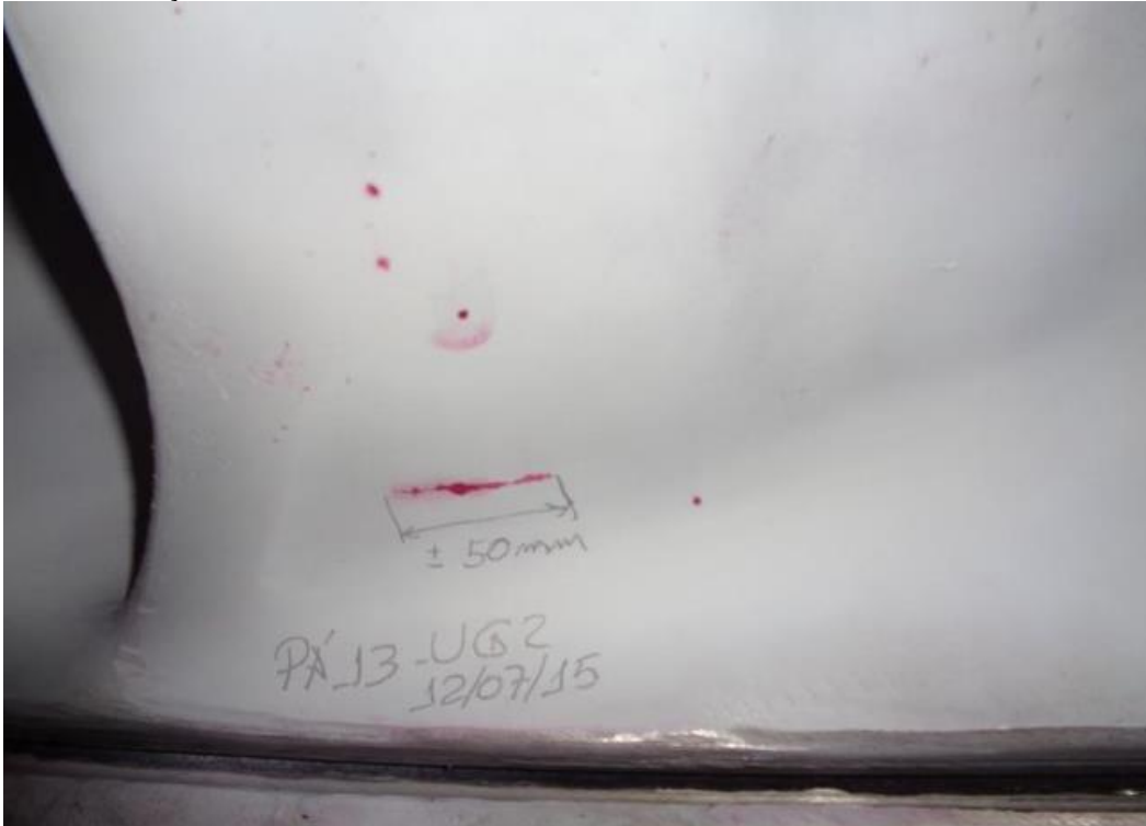
Figura 9 – Identificação das trincas encontradas no rotor da turbina
