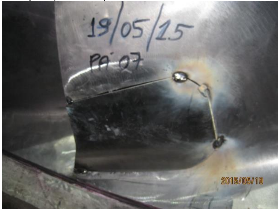
Figura 10 - Substituição de parte de uma pá do rotor da turbina
