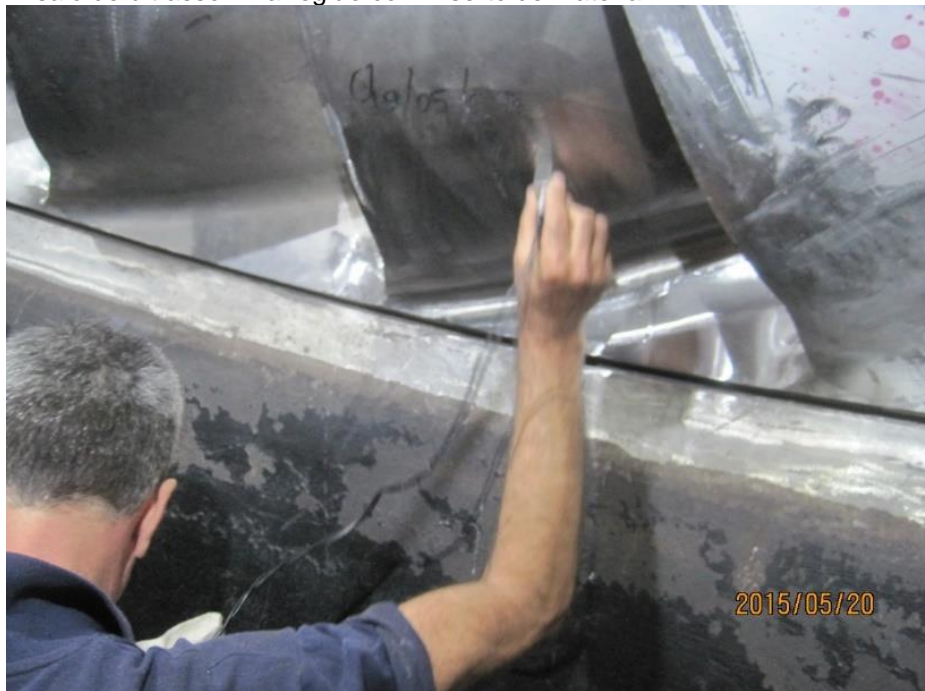
Figura 11 - Ensaio de ultrassom na região com inserto de material
