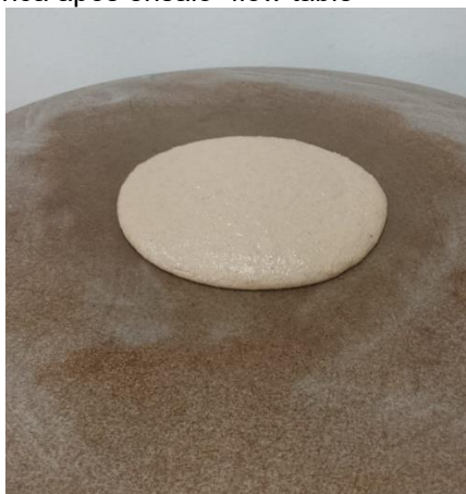
Figura 3 - Argamassa geopolimérica após ensaio “flow table”
