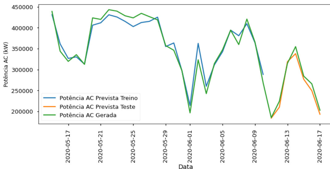
Figura 53 – Previsão para os 34 dias com modelo de rede neural LSTM com uma única variável de entrada.
