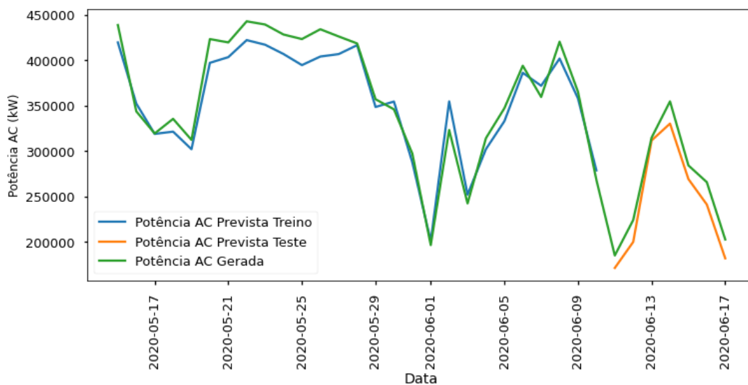
Figura 55 – Previsão para os 34 dias com modelo de rede neural LSTM com método Window e uma única variável de entrada.
