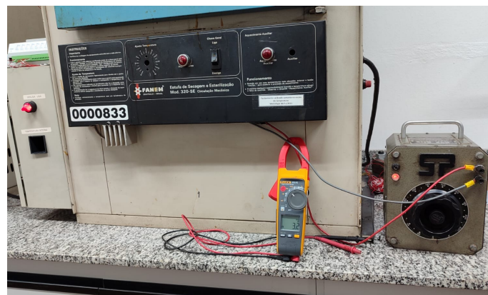
Fig. 1. Sistema experimental utilizado nos ensaios, composto pela estufa, variador de tensão e o alicate-amperímetro utilizado para monitoramento elétrico. Fonte: O autor.
