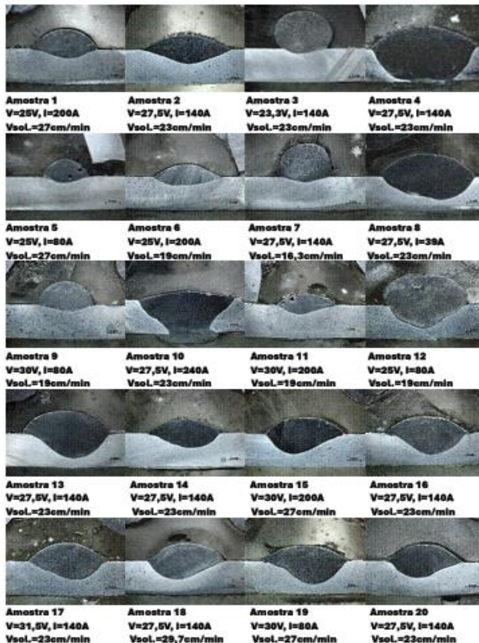
Figura 1: Imagens transversais dos depósitos, mostrando as variações de corrente e velocidade de soldagem.
