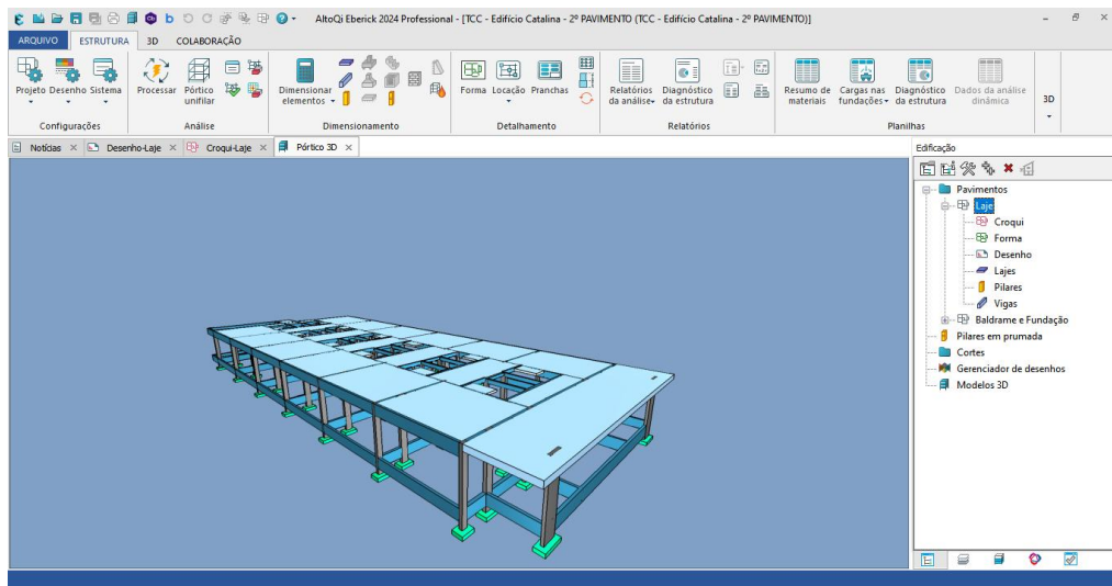
Figura 32 – Pórtico 3D gerado pelo Eberick
