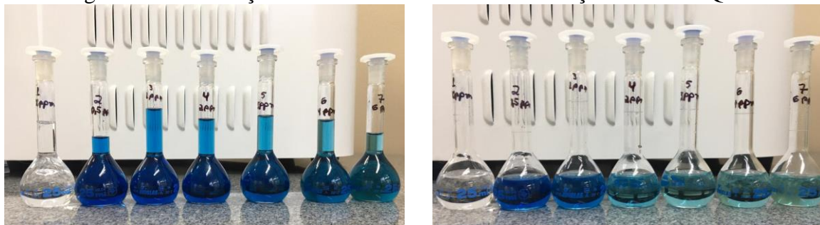
Figura 27 – Diferença das amostras de Curva de Calibração de Zero e Quatro horas.
