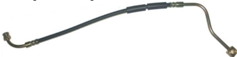
Figura 6 –Tubo Rígido e Flexível de freio
