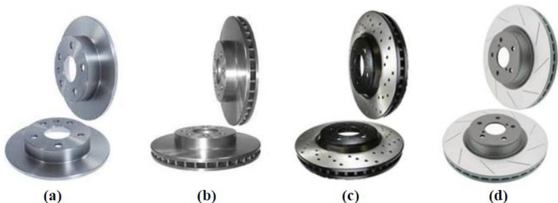
Figura 12 – Geometria utilizada nos discos de freio: (A) Disco sólido; (B) Disco ventilado; (C) Disco ventilado com pista perfurada; (D) Disco ventilado com pista ranhurada.
