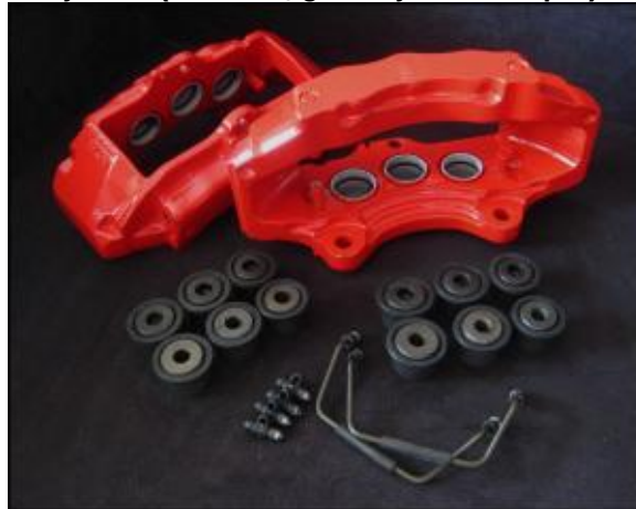
Figura 11 – Pinça fixa (cavelete, guarnição ou caliper) com 6 pistões
