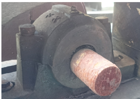
Figura 16 - Mancal do primeiro eixo danificado.
