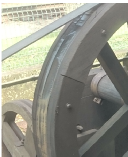
Figura 18 – Polia desgastada e correia do sistema
