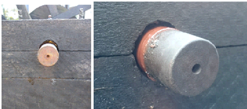
Figura 17 - Eixo acoplado direto na madeira causando desgaste.
