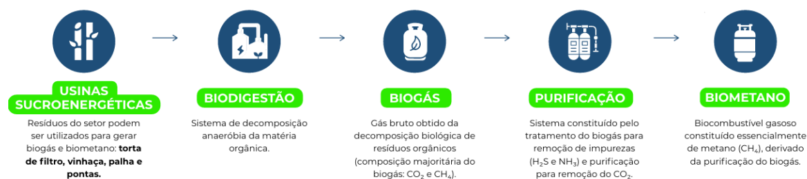
Figura 40 - Ciclo produtivo do biometano
