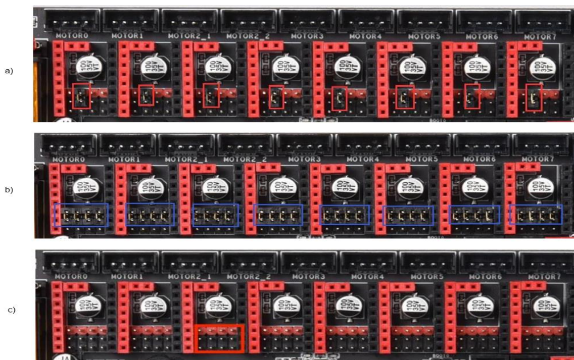
Figura 12 - Jumpers de configuração da placa Big Tree Tech Octopus: a) Modo UART, b) Modo SPI, c) Modo Step/Dir
