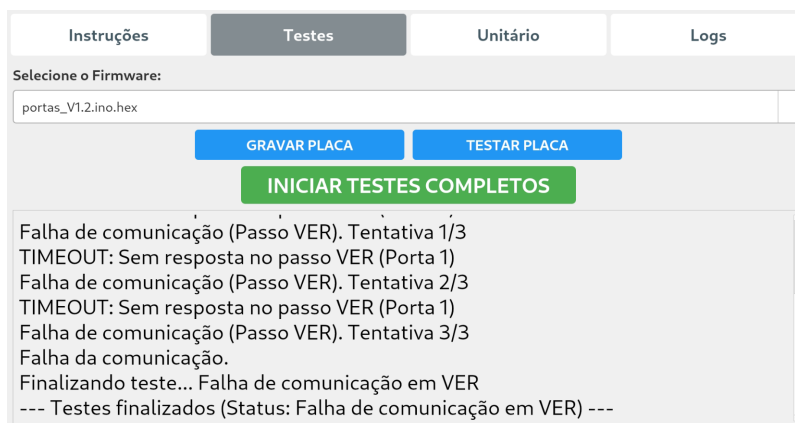
Figura 41 – Exemplo de detecção de falha de comunicação
