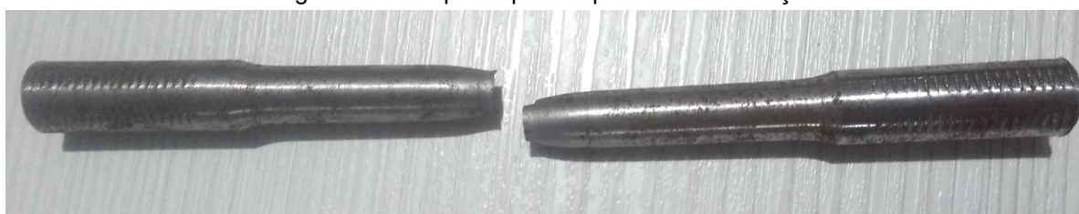
Figura 33 – Corpo de prova após ensaio de tração
