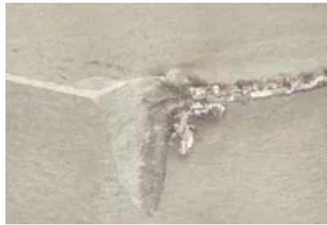
Figura 10 – Desgaste de entalhe
