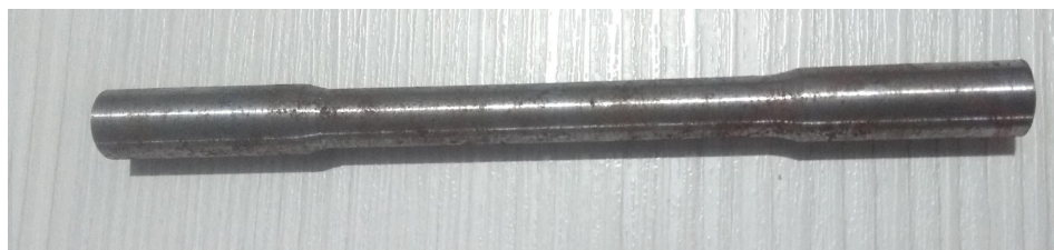
Figura 26 – Corpo de prova após forno e usinagem
