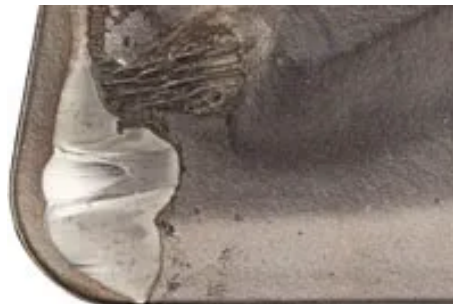
Figura 11 – Desgaste de cratera
