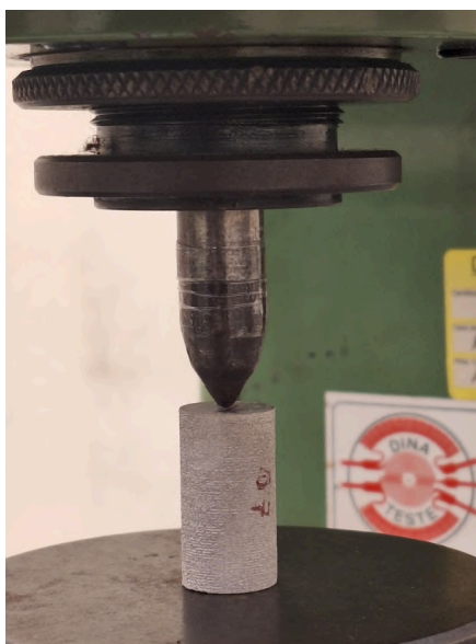
Figura 30 – Aplicação de carga no corpo de prova
