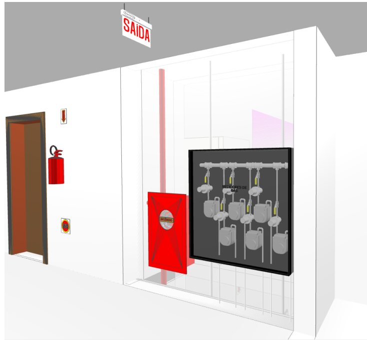
Figura 42 – Abrigo de hidrantes, abrigo de medidores de gás, extintor portátil e sinalização para abandono de local na circulação (parede com transparência)
