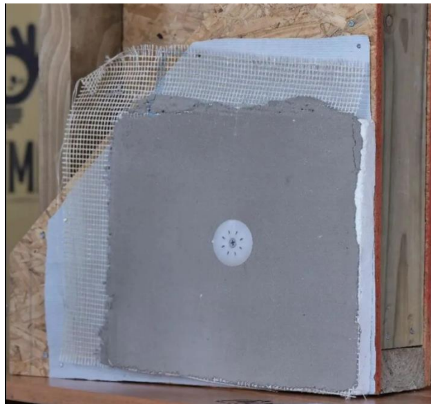
Figura 72 - Modelo de camadas do sistema EIFS utilizado no revestimento externo
