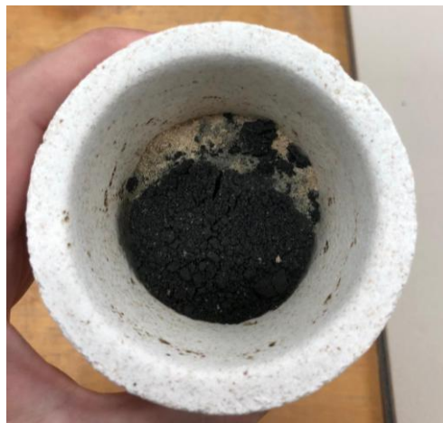
Figura 3 – Produto sólido obtido após o processo de clinquerização no forno.
