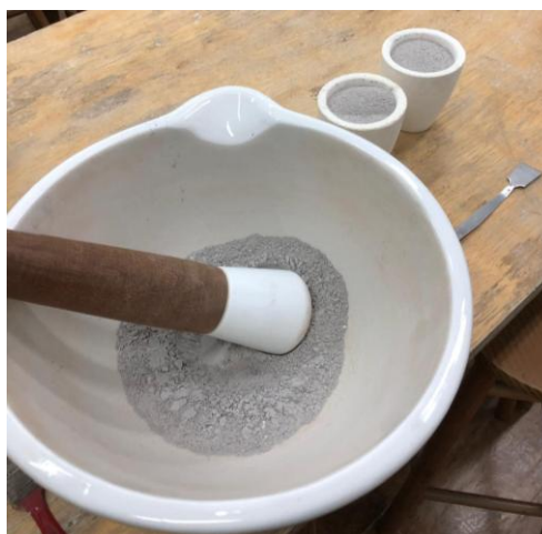
Figura 1 – Mistura homogeneizada de matérias-primas e pronta para o forno de clinquerização.
