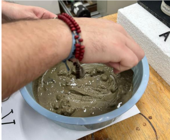
Figura 5 - Processo homogeneização manual da pasta
