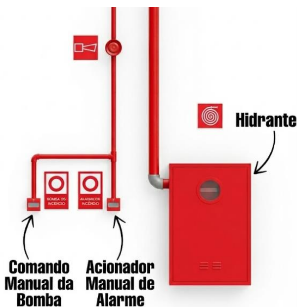
Figura 29 – Detalhe Típico de Instalação
