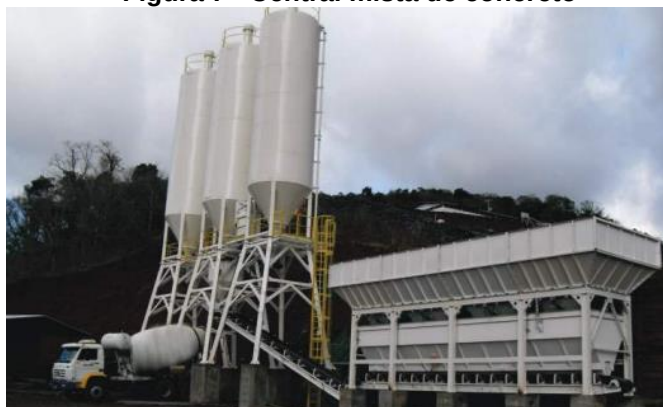
Figura 7 - Central mista de concreto
