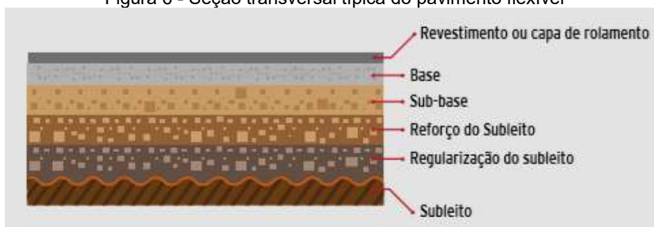
Figura 6 - Seção transversal típica do pavimento flexível
