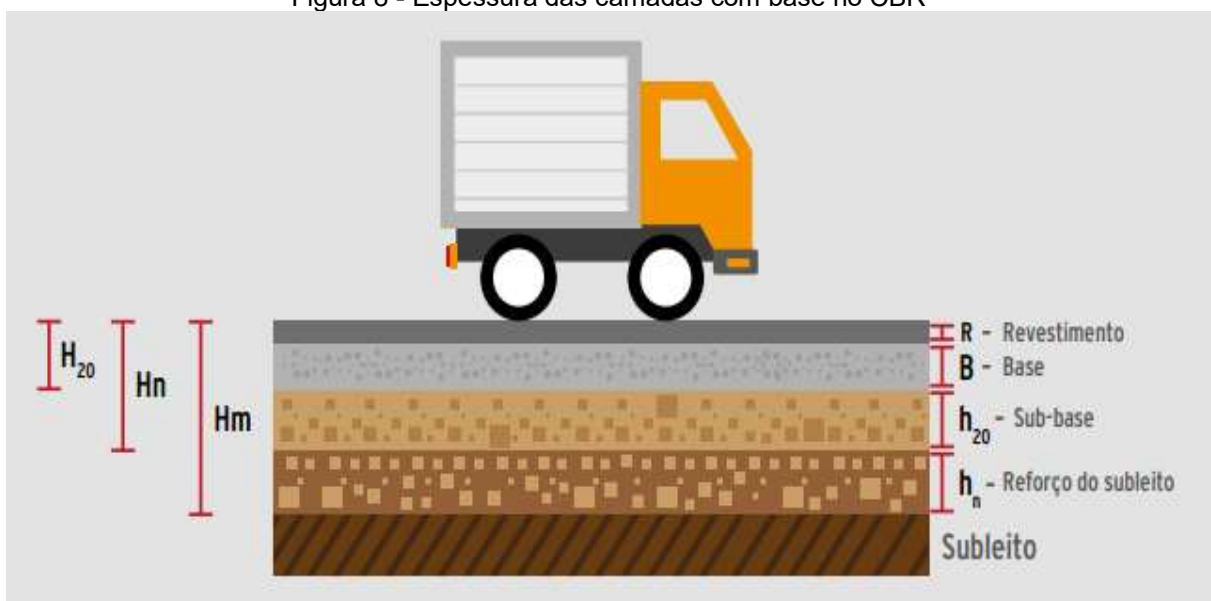
Figura 8 - Espessura das camadas com base no CBR
