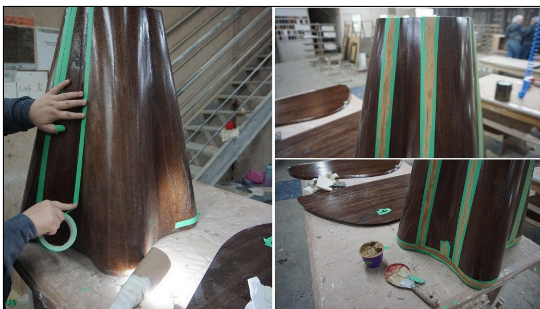
Figura 82 - Isolamento das peças, aplicação de massa e lixa 02.
