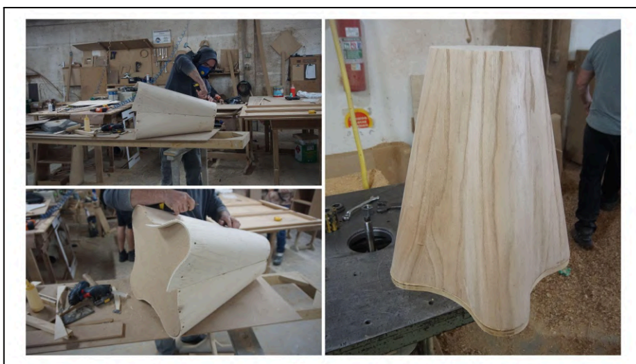
Figura 78 - Montagem da base e laminação.
