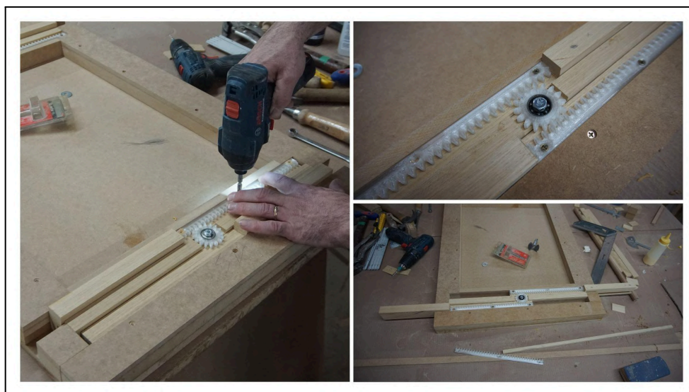
Figura 70 - Sub-tampo aberto com trilho.
