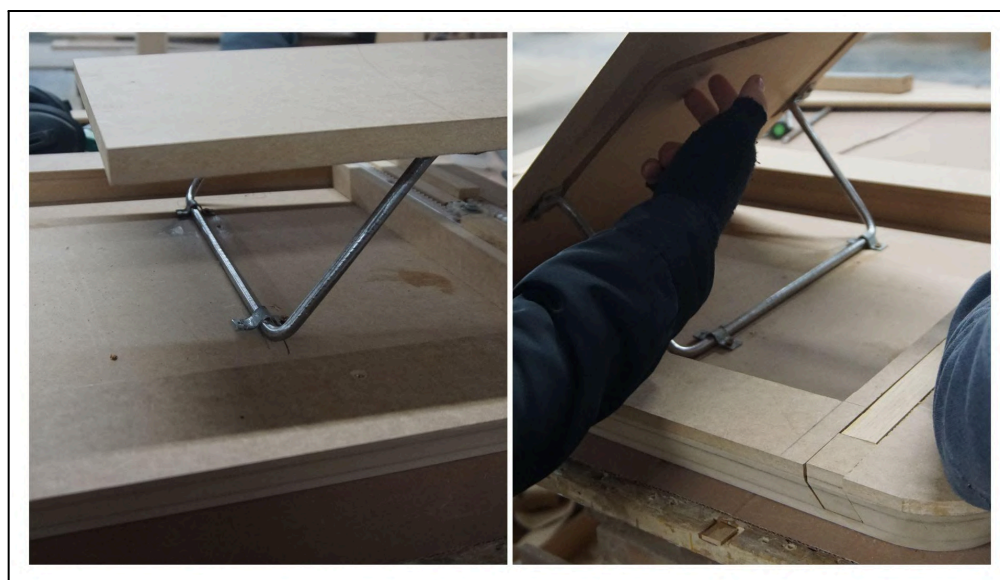
Figura 69 - Teste do sistema de extensão ( Offset Bar ).
