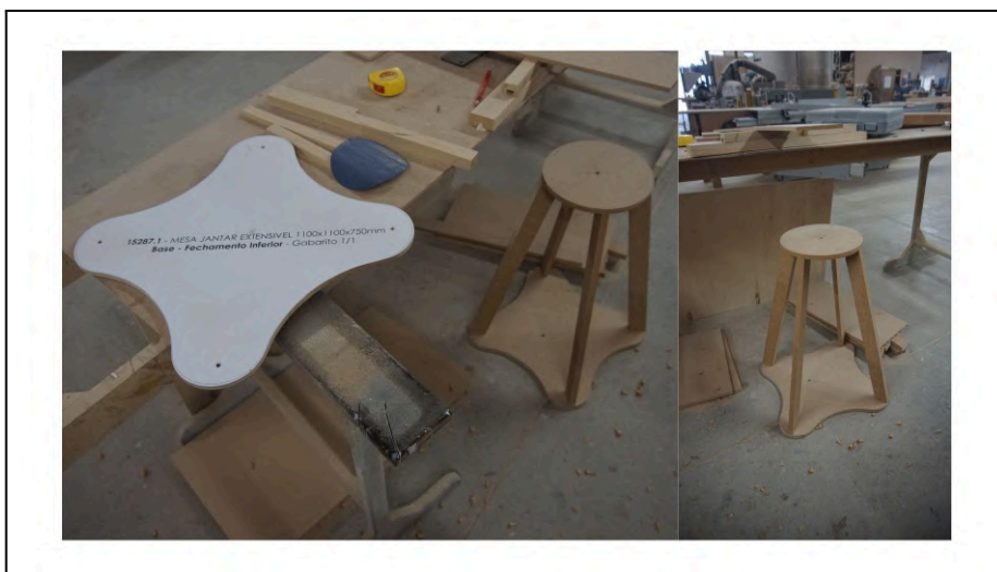
Figura 77 - Construção inicial da base.
