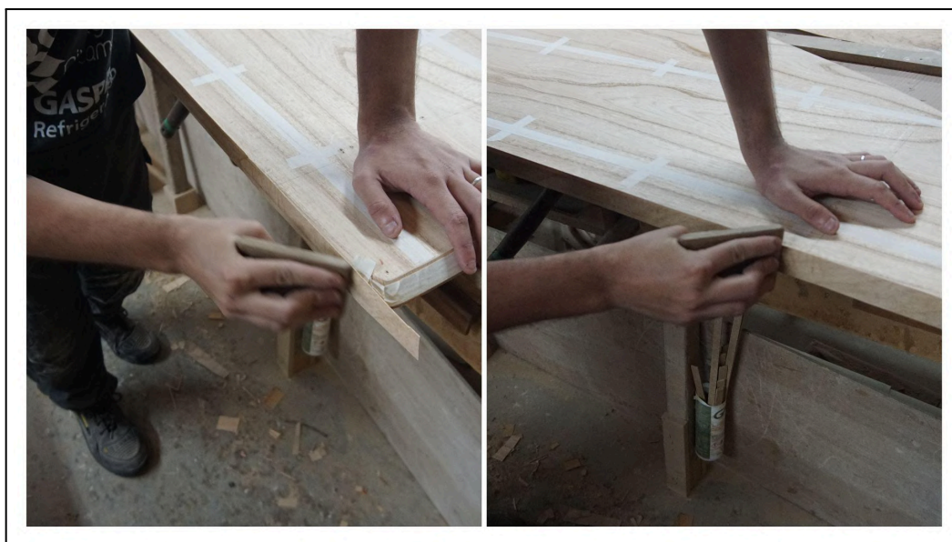
Figura 75 - Colagem de lâmina nas bordas dos tampos.
