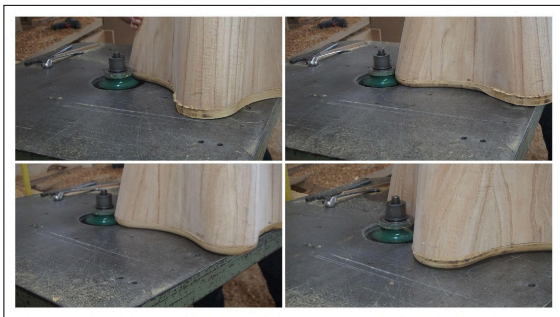
Figura 79 - Usinagem de detalhe em madeira da base.
