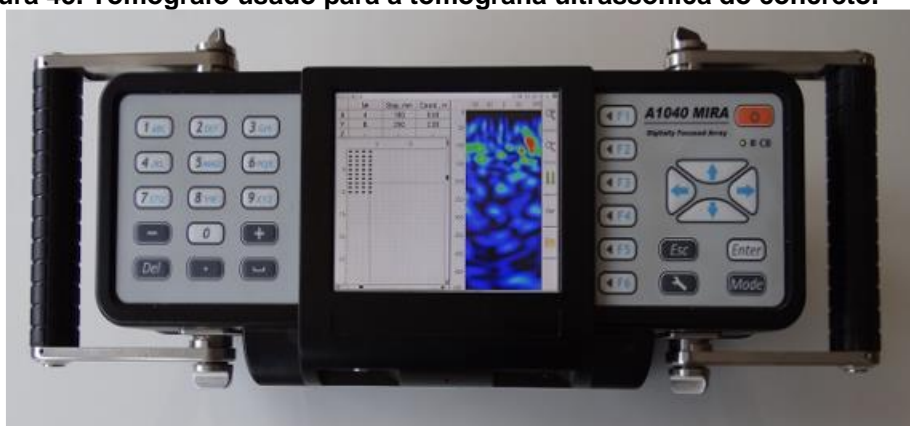
Figura 45. Tomógrafo usado para a tomografia ultrassônica do concreto.
