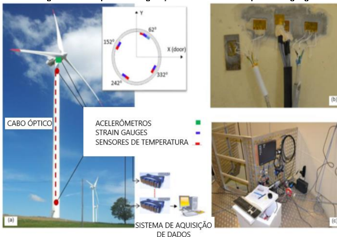
Figura 40. Exemplo de configuração de monitoramento por strain gauges .
