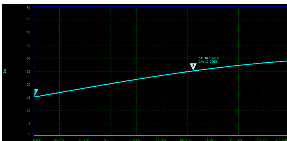
Figura 29 – Aumento da pressão do acumulador com válvula de reposição de ar.
