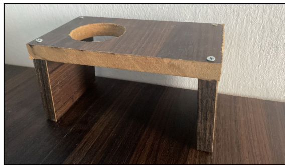
Figura 7: Protótipo de ancoragem da filmadora (Iphone 11) sobre a placa. Fonte: Autor
