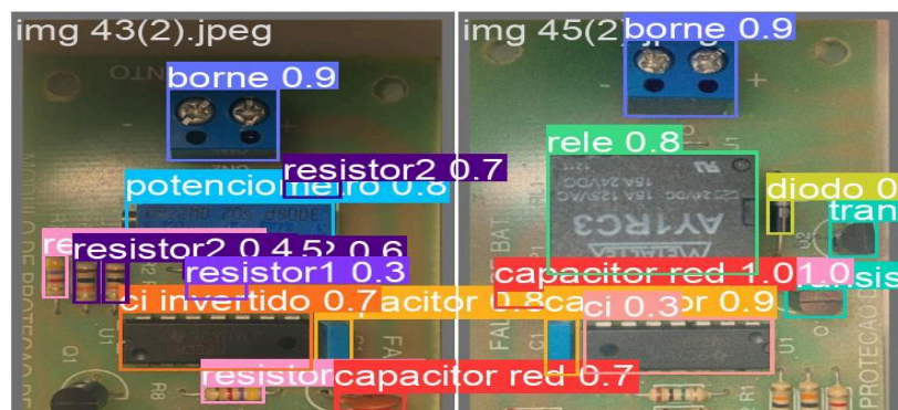
Figura 11: Resultados ampliados de predição (Validation Batch Prediction). Fonte: Autor
