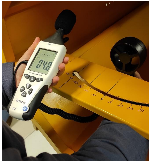
Figura 22 - Medição de velocidade com anemômetro portátil.
