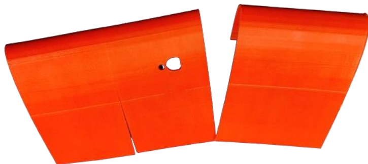
Figura 26 - Peça rompida impressa com filamento ABS.
