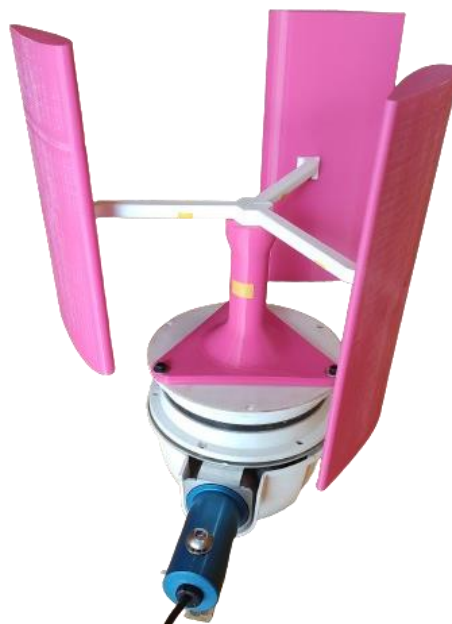
Figura 29 - Turbina montada junto ao gerador elétrico.
