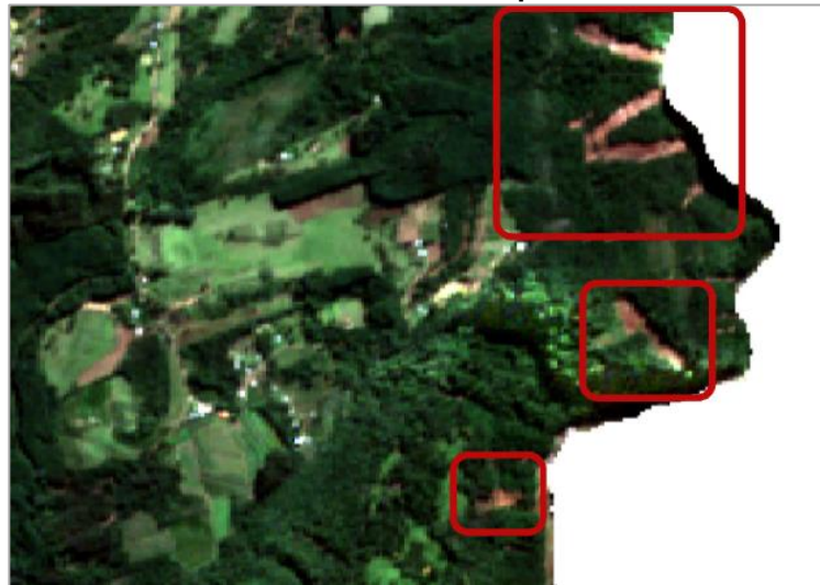
Figura 37 - Recorte da composição RGB Depois do evento extremo em Caxias do Sul – Cicatrizes Visíveis em Destaque
